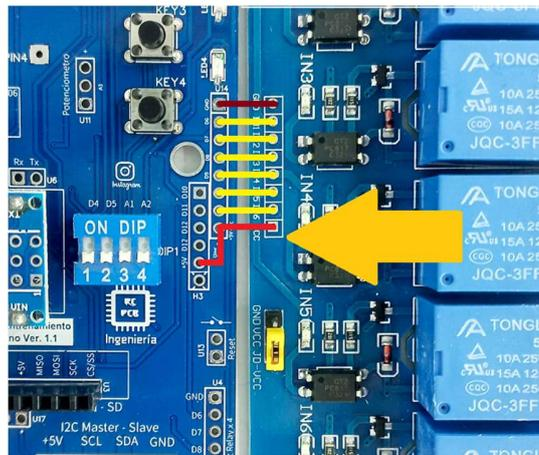
Después si lo desea y los más conveniente para su proyecto instalado en un tablero, montar ambas tarjetas en el soporte para Riel DIN.
